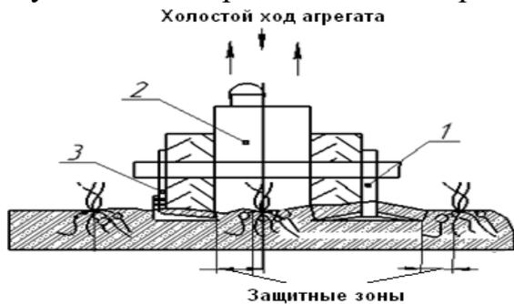
Рис. 1. Схема конструкции мини-агрегата: 1 – стрельчатая лапа; 2 – мотоблок «Зубр»; 3 – лапа «бритва»
