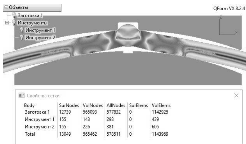
Рис. 1. QForm-моделирование калибровки трубной заготовки силовым воздействием в зоне сварного шва
