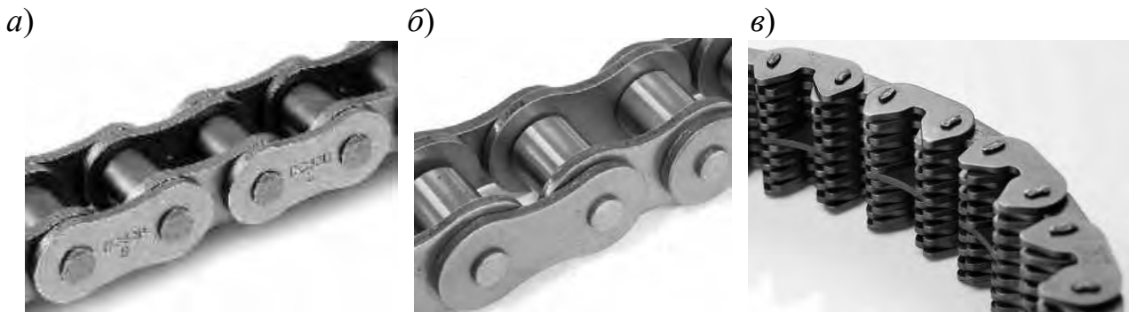
Рис. 7.2. Виды приводных цепей: а – втулочная; б – роликовая; в – зубчатая
