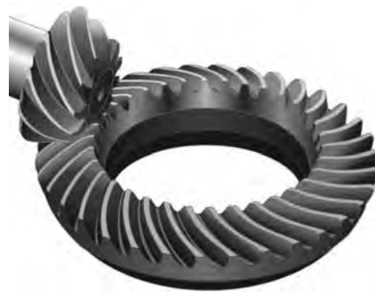
Рис. 3.1. Виды конических зубчатых передач: а – с прямым зубом; б – с тангенциальным зубом; в – с круговым зубом
