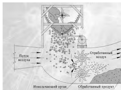
Совмещенный процесс измельчения и влагоудаления
