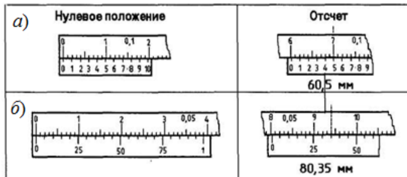
Рисунок 1.5 – Пример отсчета показаний штангенциркуля
