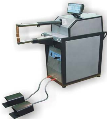
Рисунок 12 – Общий вид сварочной машины МТР 16073
