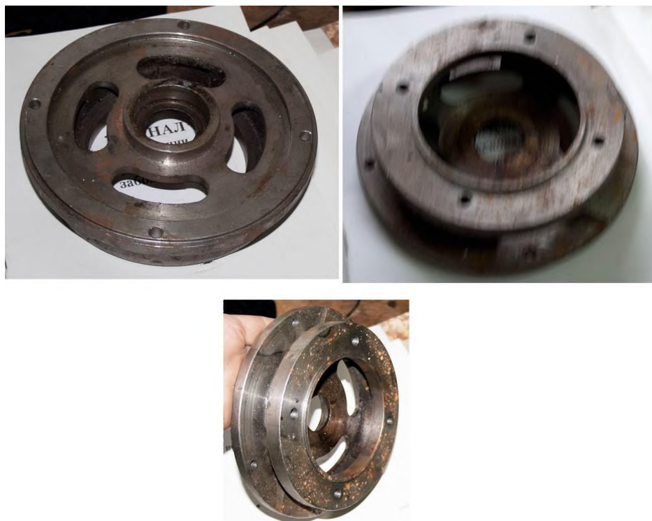
Рис. 7. Общий вид спроектированной крышки муфты привода натяжения экструдера
