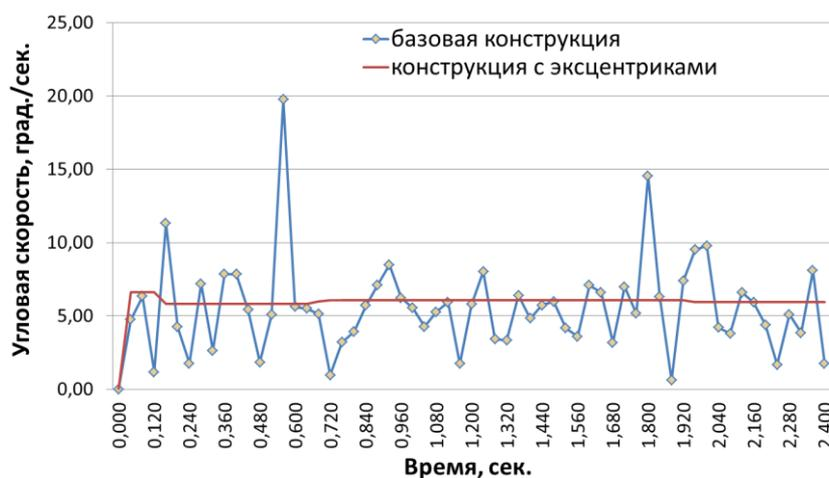
Рис. 1. Графики угловых скоростей выходного вала редуктора
