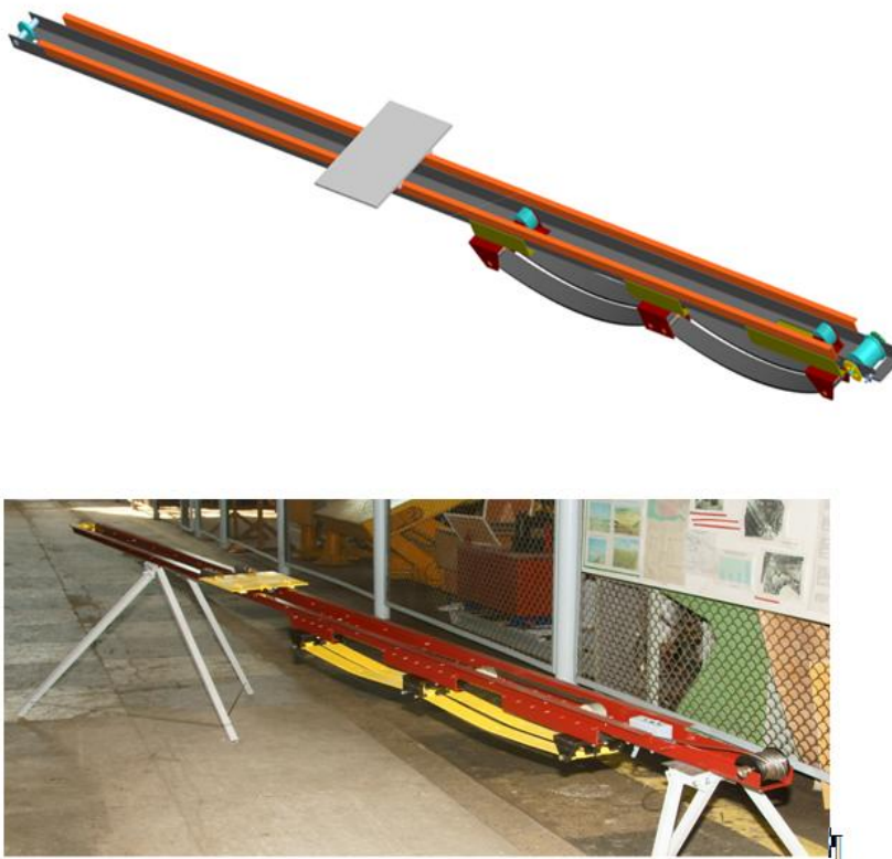
Рис. 1. Катапульта с использованием плоских пружин
