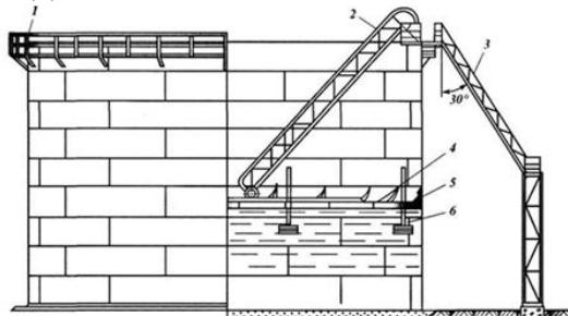
Рис. 1. Резервуар с плавающей крышей объемом до 50000 м<sup>3</sup>
