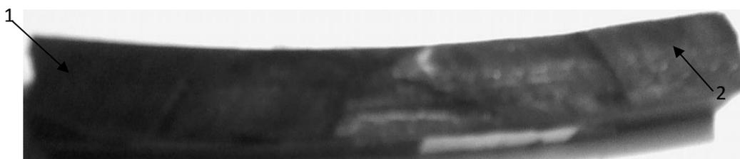
Рис. 2. Качество реза резины при ручном способе резки: 1 – поверхность реза с увеличенной скоростью подачи; 2 – поверхность реза с нормальной скоростью подачи
