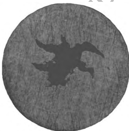
Рис. 3. Разрушение на оси заготовки при ПП
