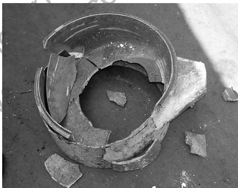
Рис. 5. Вид поврежденного корпуса приемника высокожирных сливок
