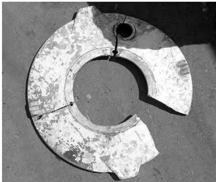
Рис. 4. Вид поврежденной крышки приемника высокожирных сливок
