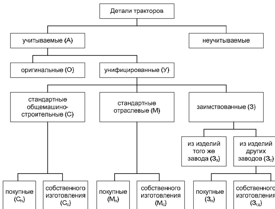
Рис. 2. Классификация деталей трактора
