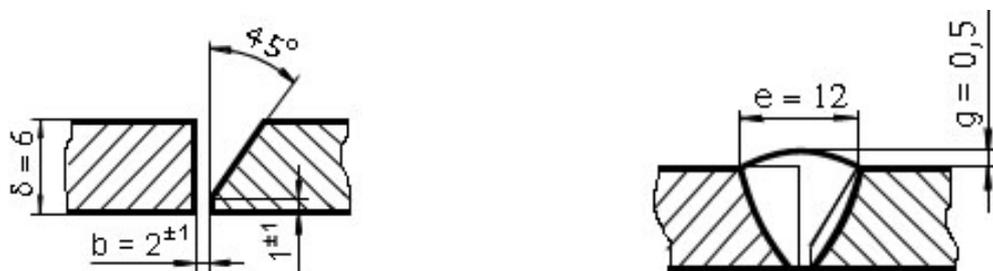
Рисунок 2.1 – Эскиз сварного соединения
