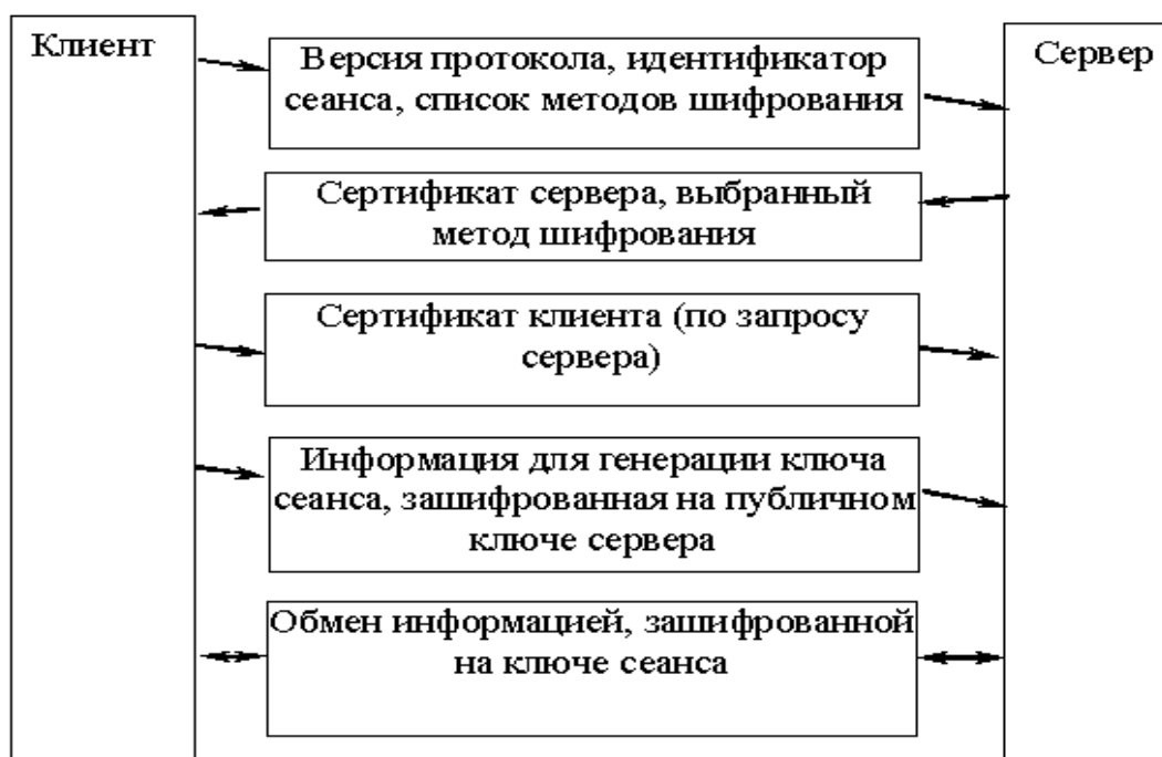
Рисунок 8.1 – Обобщенная схема установки соединения по протоколу SSL
