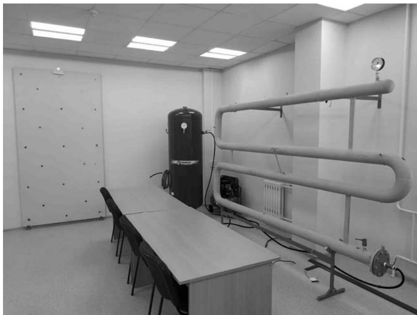
Рисунок 5.1 – Лабораторный стенд для акустико-эмиссионного контроля
