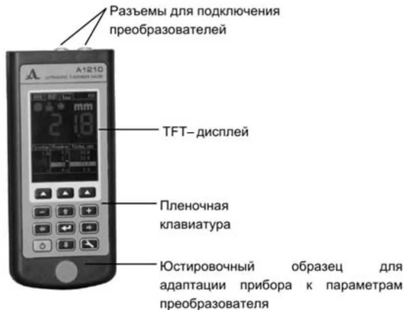
Рисунок 4.6 – Внешний вид толщиномера А1210
