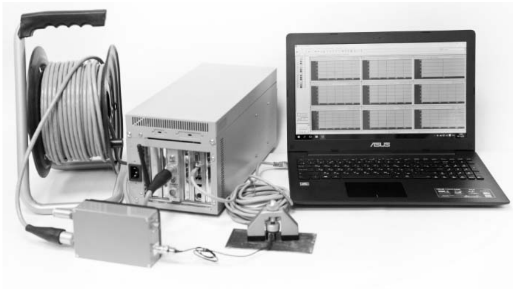
Рисунок 5.2 – Акустико-эмиссионная система Лель (A-Line 32D (DDM)) компании «ИНТЕРЮНИС»
