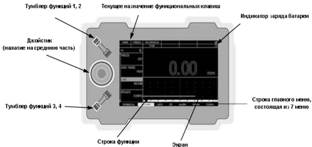
Рисунок 4.7 – Передняя панель прибора DMS Go
