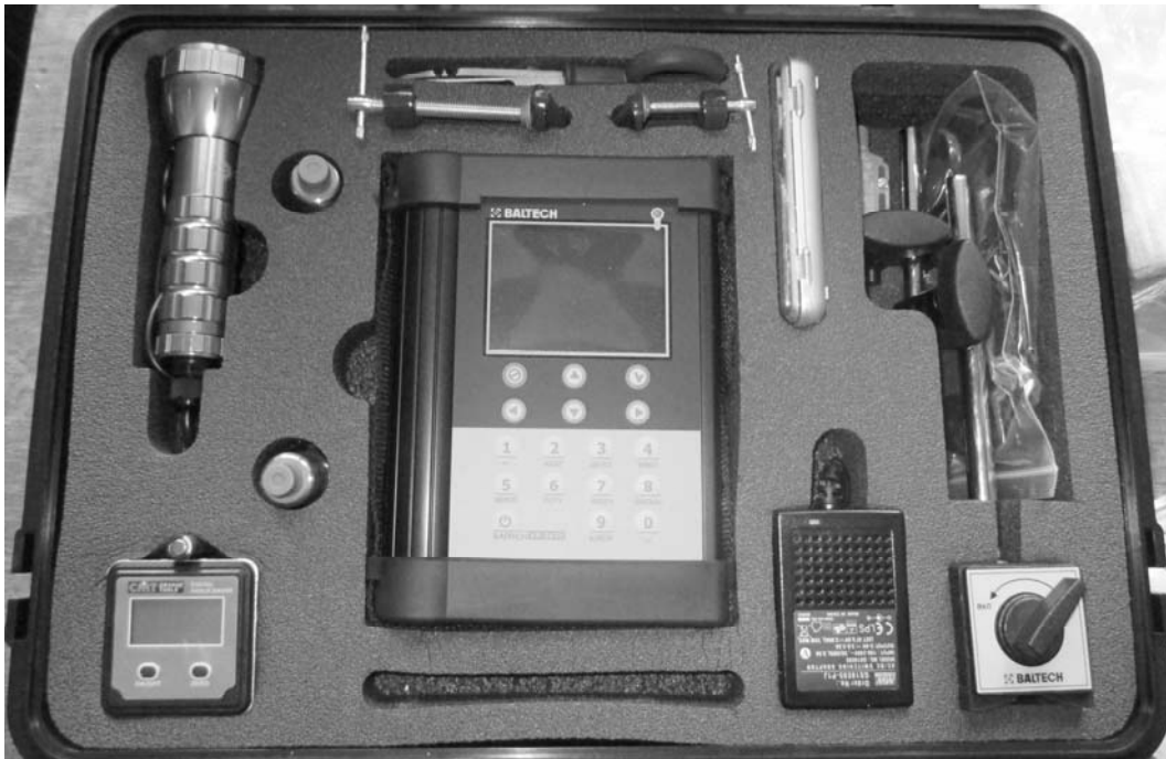
Рисунок 2.3 – Схема оборудования для уравнивания ротора
