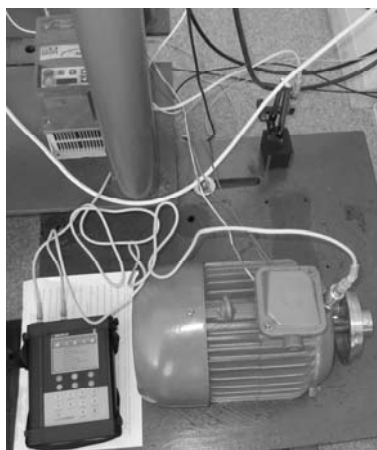
Рисунок 2.4 – Стенд для одноплоскостного уравнивания ротора
