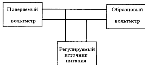
Рисунок 2.8 – Схема включения приборов для поверки вольтметра
