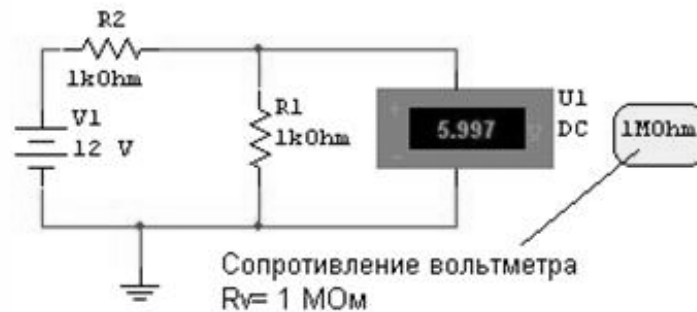
Рисунок 8.3 – Измерение напряжения при помощи вольтметра
