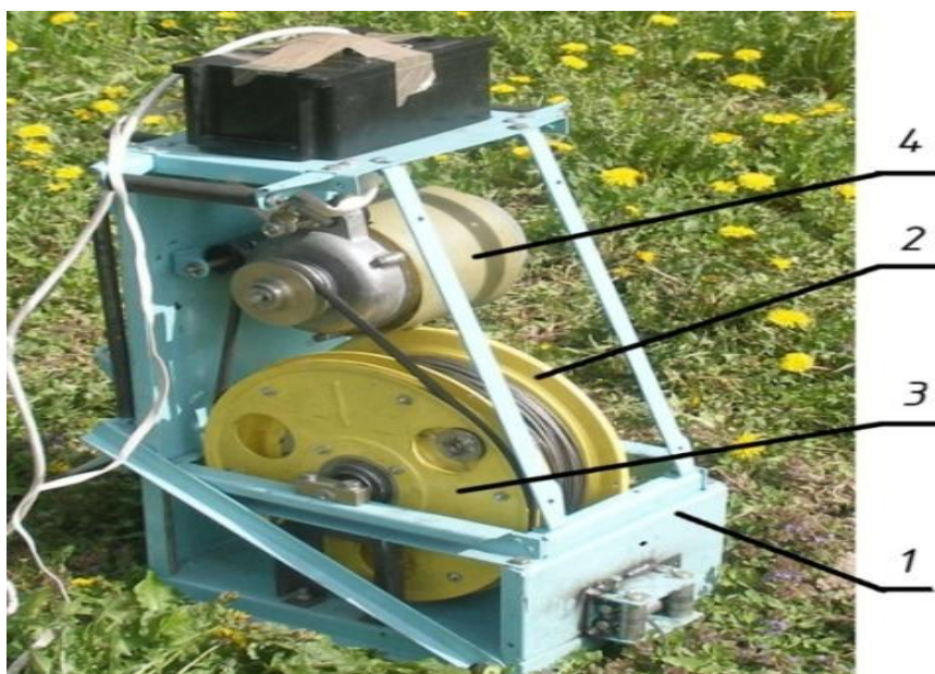
Рис. 2. Общий вид экспериментального образца лебедки сельскохозяйственной, разработанной на основе прецессионного редуцирующего механизма: 1 – корпус лебедки; 2 – барабан с прецессионным редуктором; 3 – шкив; 4 – электродвигатель
