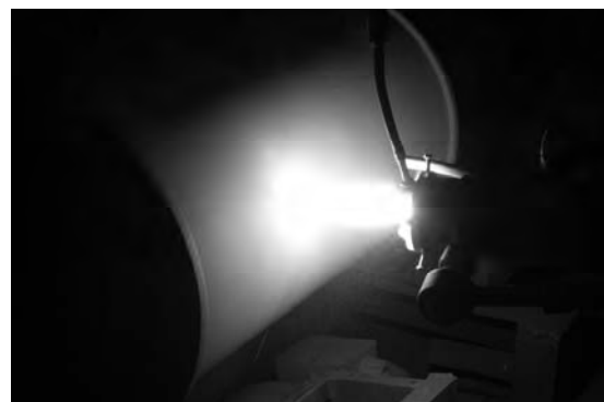
Рис. 9. Напыление покрытий с пульсирующей (а) и обычной (б) подачей порошкового материала в дуговую плазму
