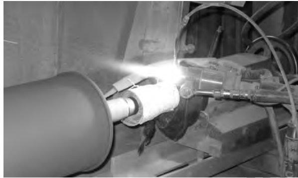
Рис. 8. Напыляемая деталь и плазматрон, работающий без подачи порошка
