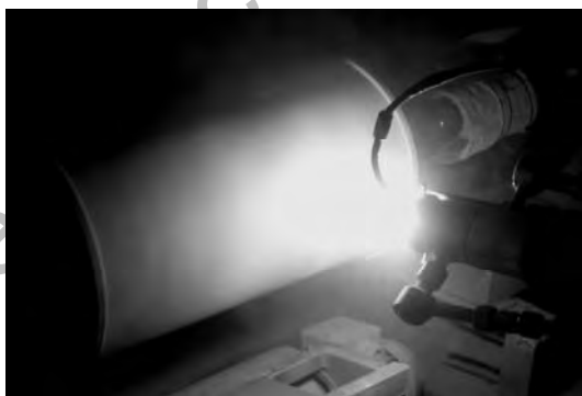
Рис. 9. Напыление покрытий с пульсирующей (а) и обычной (б) подачей порошкового материала в дуговую плазму
