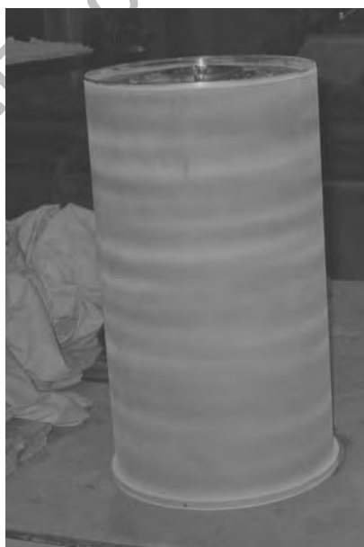
Рис. 10. Деталь с напыленным керамическим покрытием
