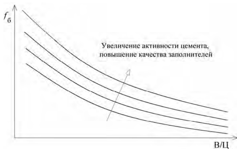
Рис. 1. Зависимость прочности бетона f_b от водоцементного отношения В/Ц
