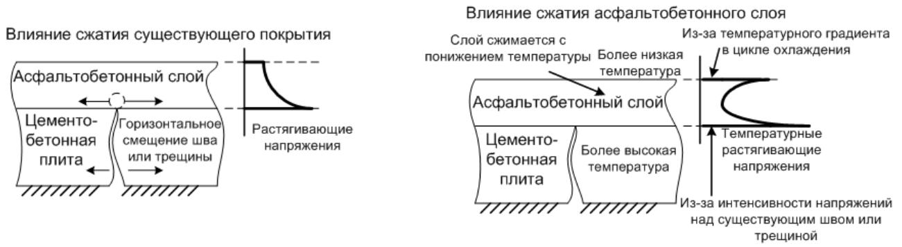
Рисунок 5 – Напряжения в асфальтобетонном слое покрытия на цементобетонном основании, вызванные суточными колебаниями температуры
