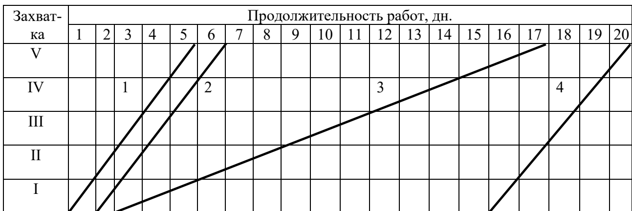
Рисунок 7 – Циклограмма специализированного кратноритмичного потока до уравнивания
