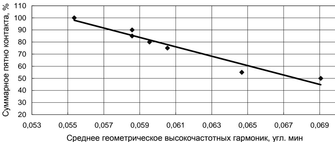
Рис. 3. Зависимость суммарного пятна контакта от среднего геометрического высокочастотных гармоник кинематической погрешности
