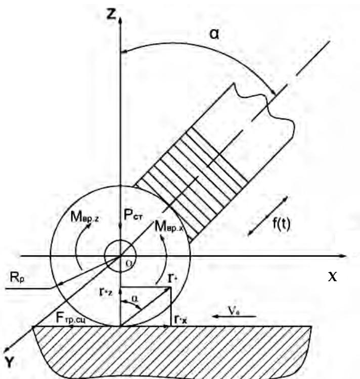
Рис. 2. Расчетная схема контактного взаимодействия ролика с подвижной поверхностью при сообщении ему ультразвуковых колебаний, направленных под углом к вертикальной оси
