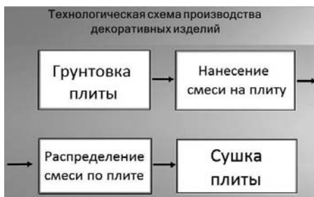
Рисунок 3. Технологическая схема производства декоративных изделий
