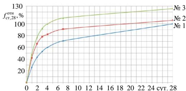
Рис. 1. Тенденция кинетики твердения бетона в нормально-влажностных условиях:
