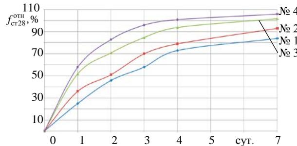
Рис. 2. Тенденция роста прочности бетона (класс C<sup>25</sup>/<sub>30</sub>) с добавкой 1 % УКД-1 в металлических теплоизолированных формах; № 1–4 – для температуры среды t<sub>нб</sub> = 5–8; 12–15; 18–22 и 25–30 °С соответственно
