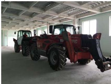
Рис. 2. Опытное нагружение перекрытия в здании:
