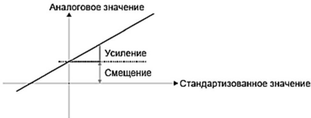
Рисунок 4.2 – Порядок преобразования аналогового сигнала в контроллере LOGO
