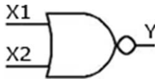
Рисунок 1.10 – Условное обозначение логического элемента ИЛИ-НЕ (NOR) за рубежом
