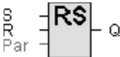
Рисунок 6.1 – Реле с блокировкой (защелкой)
