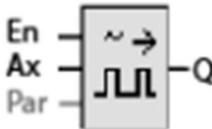
Рисунок 7.5 – Схема блока широтно-импульсного модулятора
