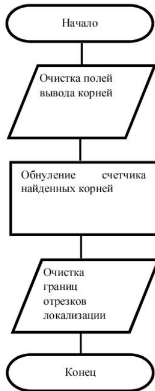
Рисунок Б.2 – Блок-схема алгоритма процедуры очистки формы с обнулением счетчика корней
