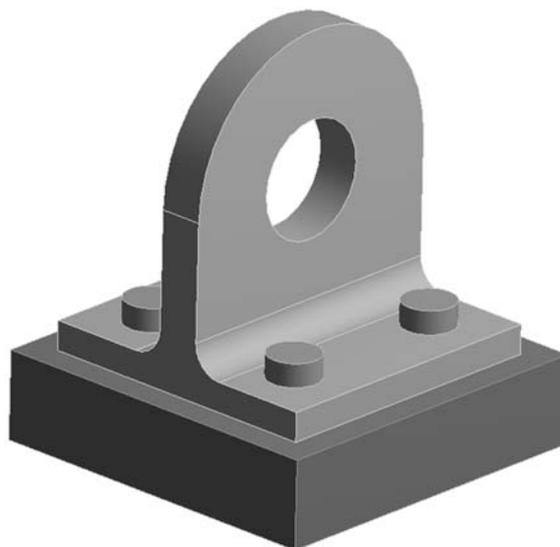
Рисунок 10.1 – Болтовое соединение проушины и основания
