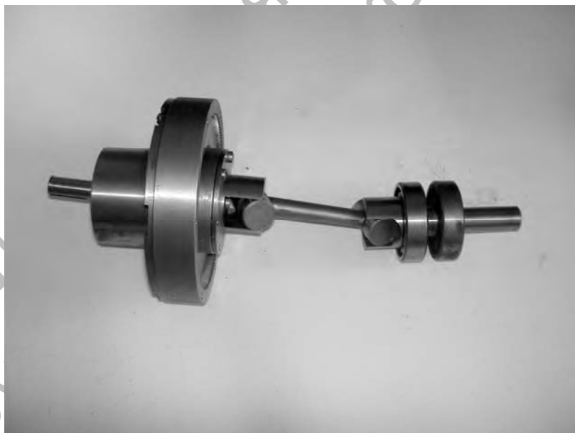
Рис. 3. Фотография макета планетарного механизма с пальцевым карданом
