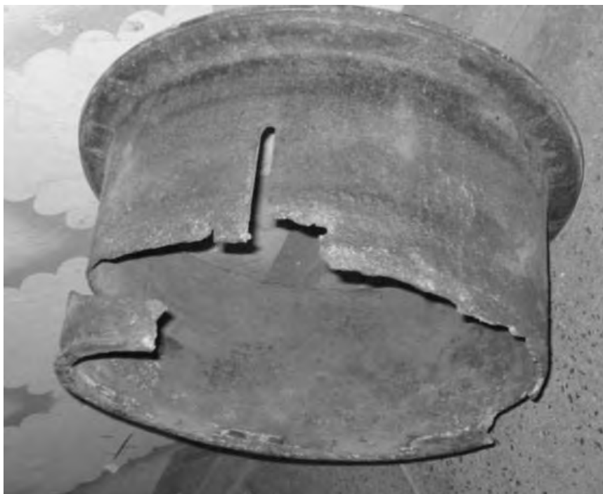
Рис. 7. Обод бездискового разборного колеса, поврежденный при эксплуатации
