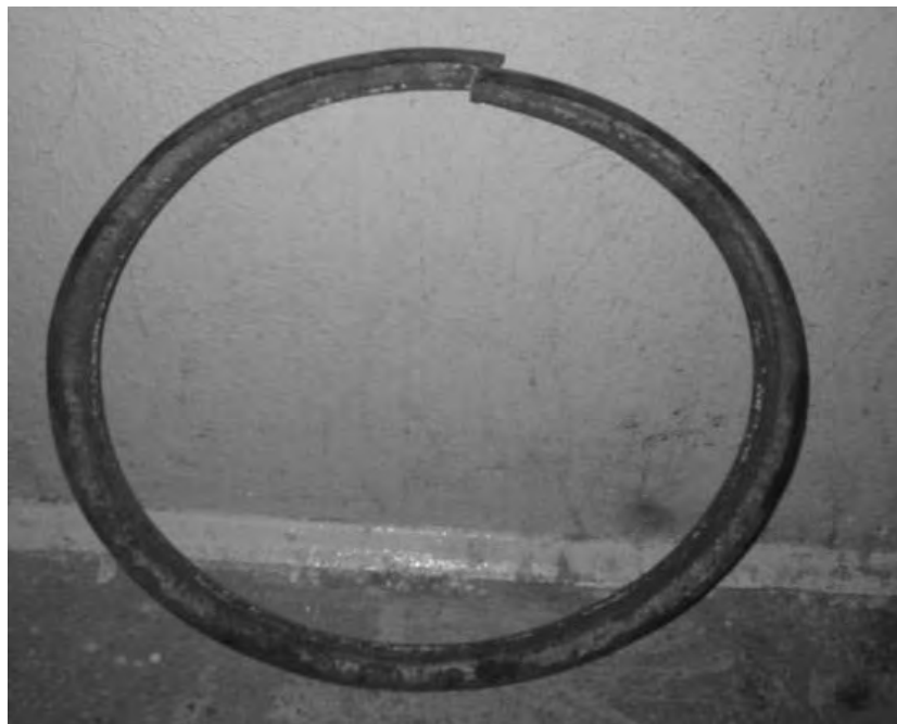
Рис. 8. Бортовое кольцо бездискового разборного колеса, поврежденное по сварочному шву
