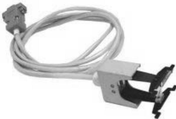
Рисунок 1.9 – Тензометрический датчик деформации ДДТ
