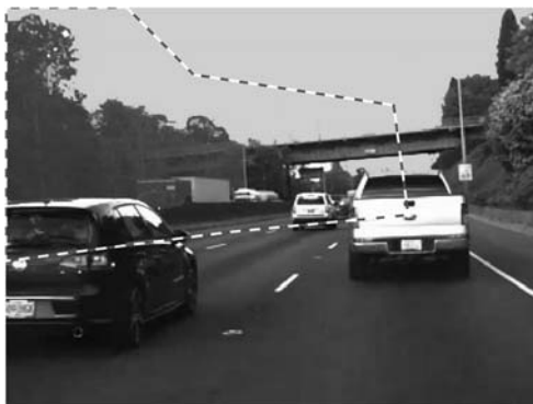
Рисунок 5.3 – Создание меток с помощью инструмента Smart Polygon
