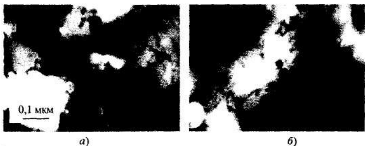
Рис. 6. Структура компактного материала, полученного из композиции Ni + 3 % Al + 8 MoO 3 (ПЭМ)
