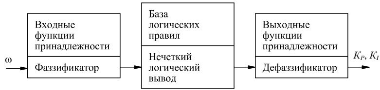
Рис. 7. Структура нечеткого регулятора
