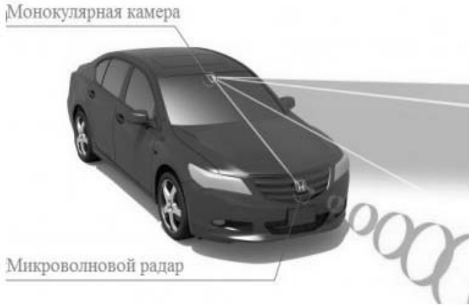
Рис. 2. Расположение приборов технического зрения на автомобиле
