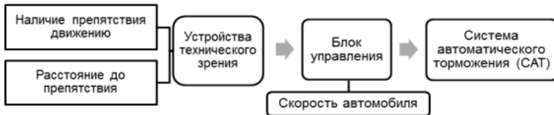
Рис. 1. Структурная схема автоматической системы экстренного торможения
