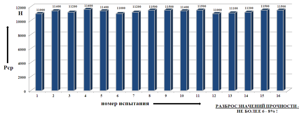
Рисунок 12. – Диаграмма прочностных испытаний рельефных пакетных соединений ( P_{CP} – усилие разрушения при испытании на срез)
