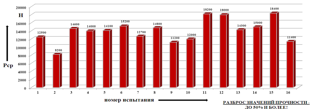
Рисунок 1. – Диаграмма прочностных испытаний точечных пакетных соединений ( P_{cp} – усилие разрушения при испытании на срез)
