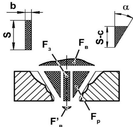
*a* – подготовка соединения под сварку и основные геометрические параметры шва; *б* – составляющие площади поперечного сечения наплавленного металла шва
