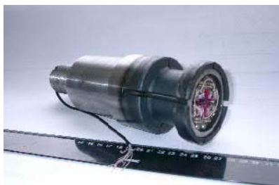
Общий вид шкворня с датчиком измерения сил
