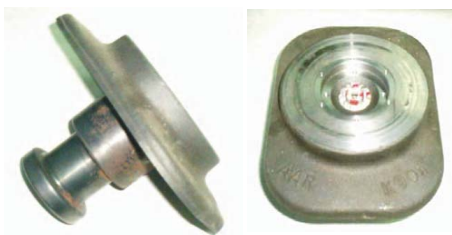
Шкворень полуприцепа седельного автопоезда с фланцем крепления, включающий датчик измерения сил взаимодействия между тягачом и полуприцепом
