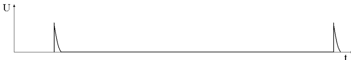
Рисунок – 2.5 Импульсы напряжения на выходе второй дифференцирующей цепи при перемещении кузова в процессе торможения автомобиля
