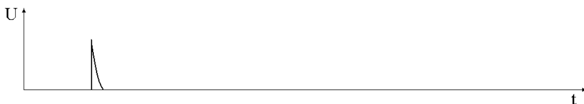
Рисунок – 2.4 Положительный импульс напряжения на выходе первой дифференцирующей цепи с отсекающим диодом
