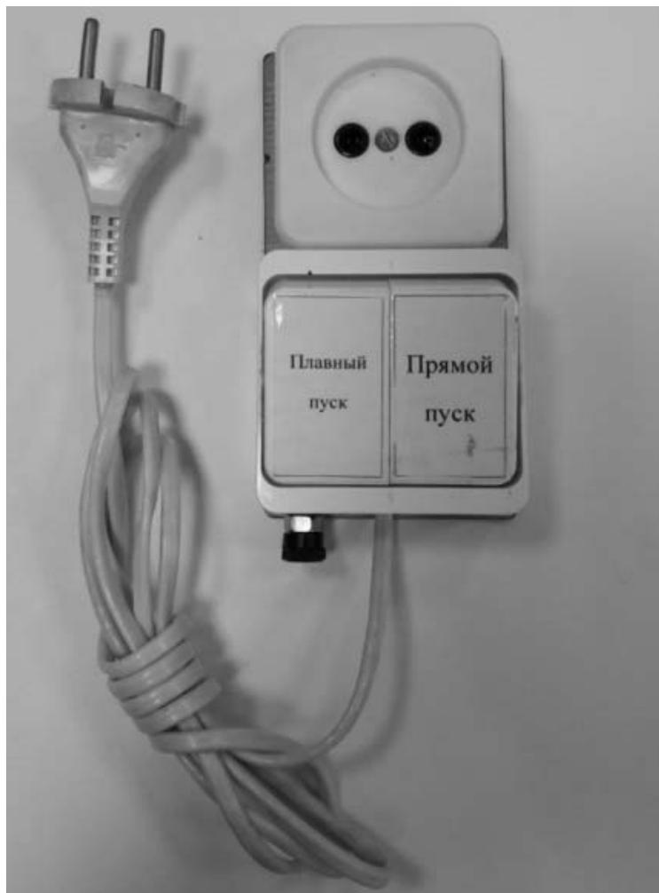
Рис. 4. Внешний вид устройства плавного пуска
