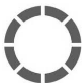
Рисунок 6.4 – Кольцо с разрезами
