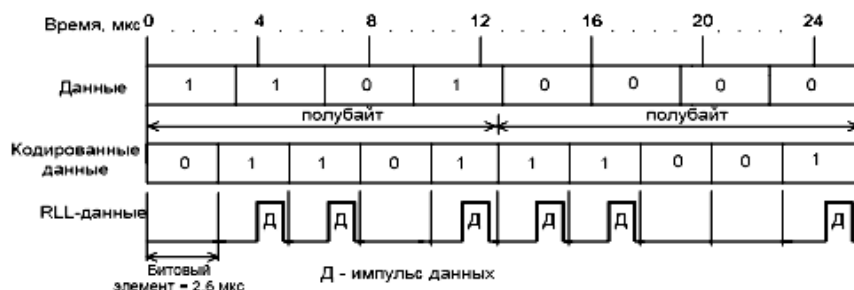
Рисунок 10.3 – Запись с групповым кодированием (RLL)
