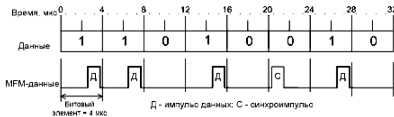
Рисунок 10.2 – Модифицированная частотная модуляция (MFM)
