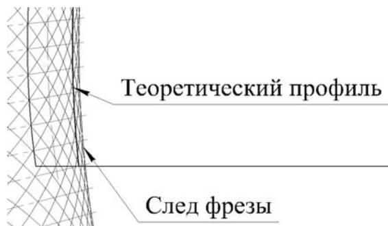
Рис. 2. Формирование погрешности внутреннего диаметра
