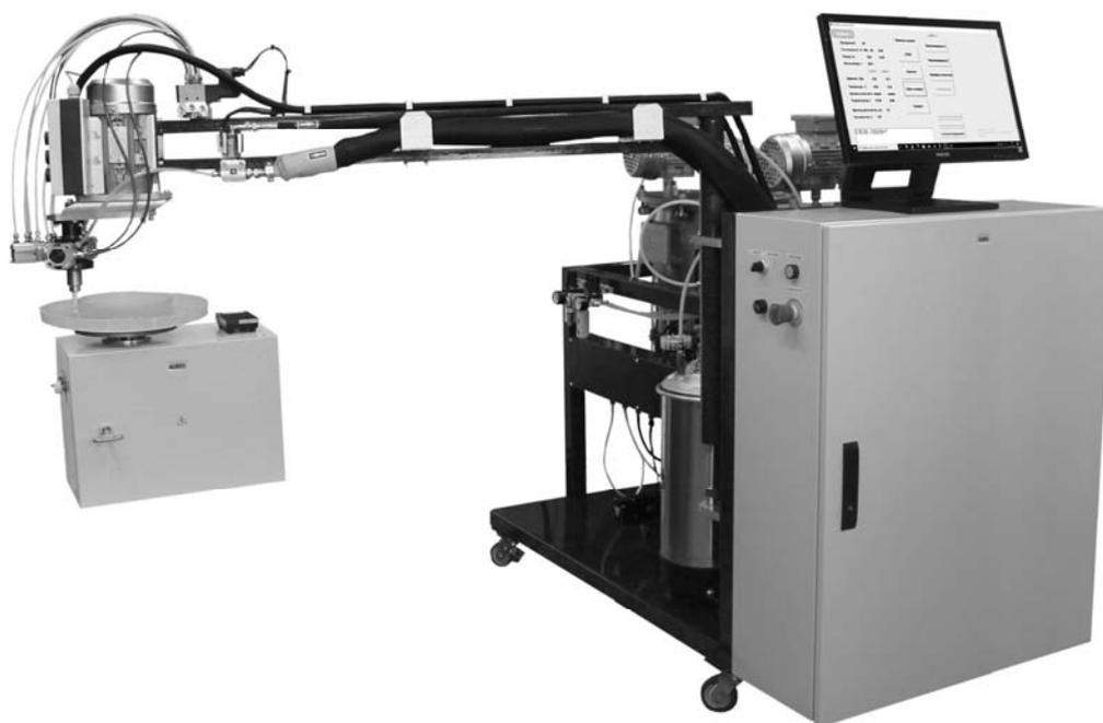
Рис. 1. Заливочно-смесительная установка для производства уплотнительных элементов круглых фильтров из пенополиуретанов
