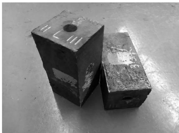
Рис. 1. Отбойные плиты для центробежно-ударной мельницы МЦ-1,25
